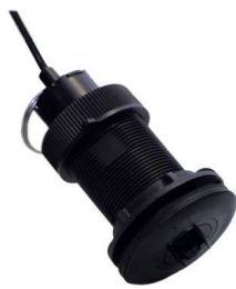
スピード・ログトランスジューサー TH52: 船底穴明け径 52mm
